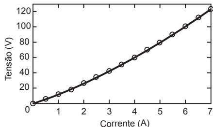
Após a análise do gráfico, ele concluiu que a tensão em função da corrente é dada pela equação  $V = 10i + i^2$ . O gráfico da resistência elétrica ( $R$ ) do resistor em função da corrente ( $i$ ) é
